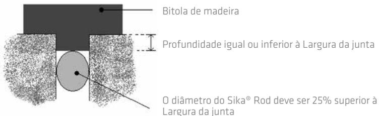
A colocação deve ser efetuada por compressão lateral do cordão contra as laterais da junta. Deve ser introduzido à profundidade previamente definida através de um instrumento auxiliar semelhante ao da figura (bitola de madeira).
